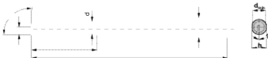
Bohrstange mit zylindrischem Hartmetallschaft und innerer Kühlmittelzufuhr.
