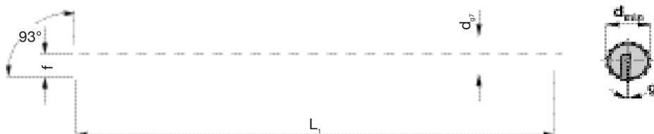
Bohrstange mit zylindrischem Hartmetallschaft und innerer Kühlmittelzufuhr.
